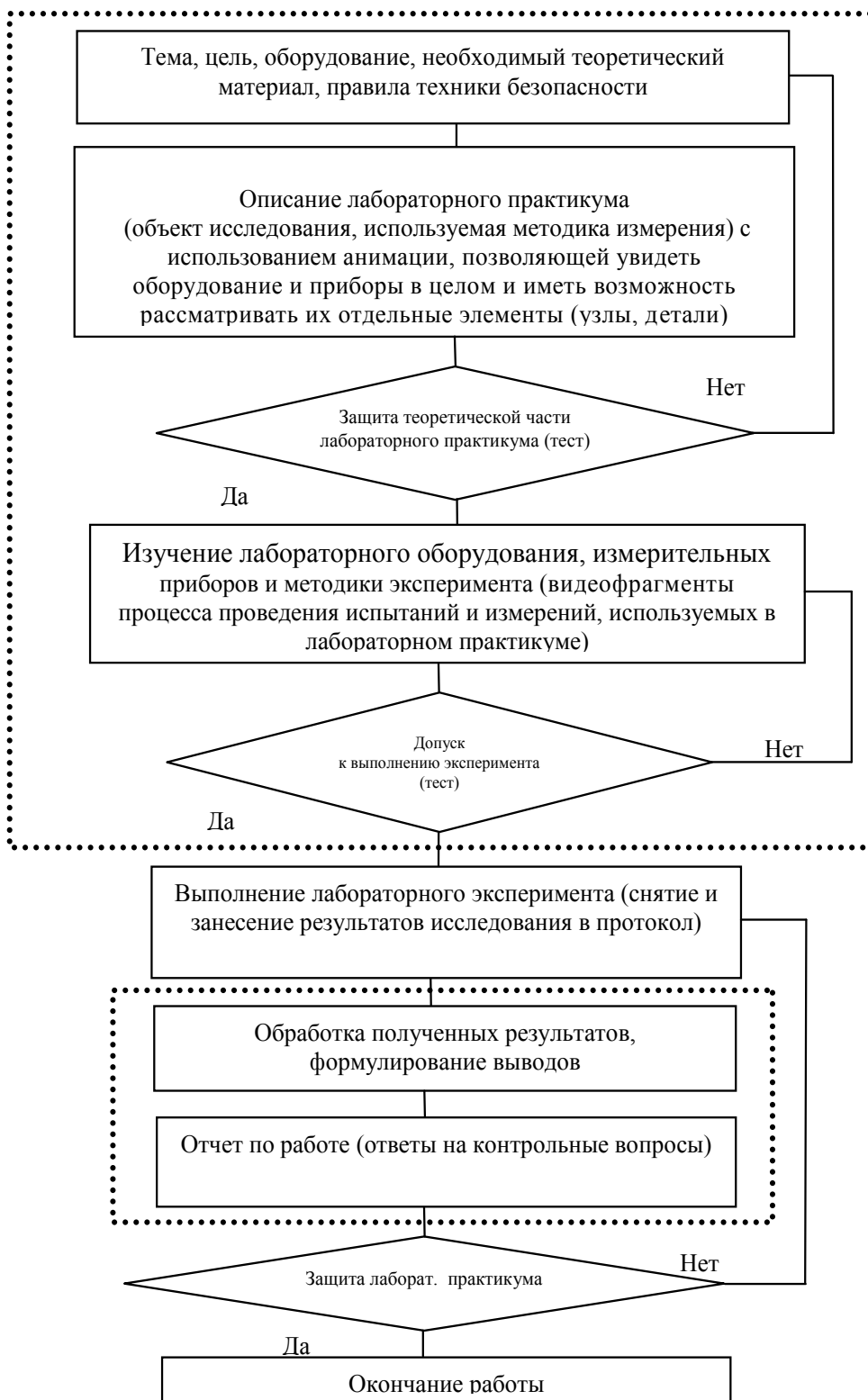
Рис. 3. Алгоритм проведения лабораторного практикума с использованием средств компьютерной поддержки
