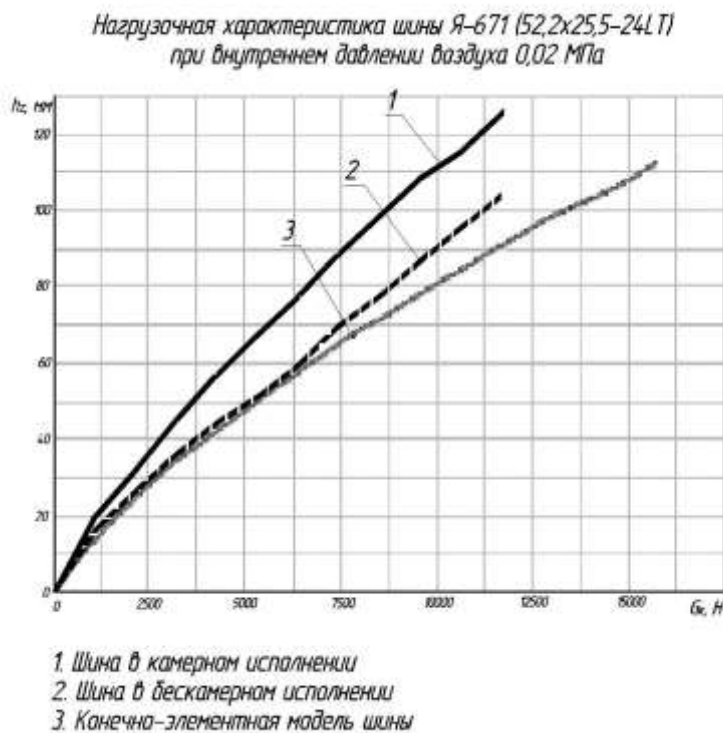
Рис. 4. Нагрузочные характеристики шин
