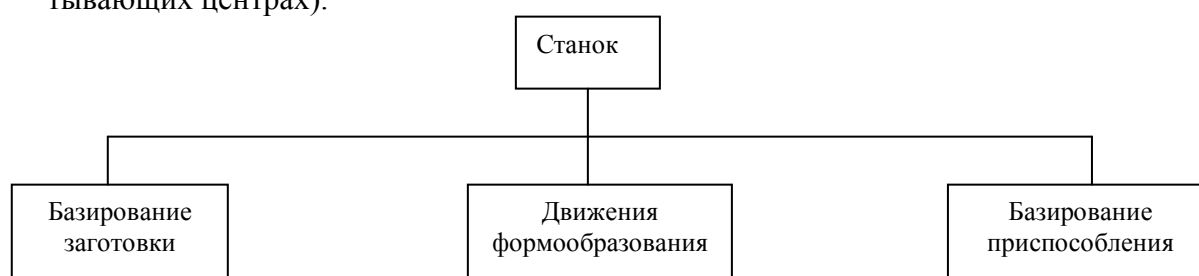
Рис. 1. Функциональная схема станка
