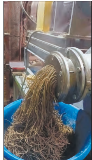
Рис. 9. Решетка с отверстиями диаметром до 2 мм Fig. 9. Grid with holes up to 2 mm in diameter
