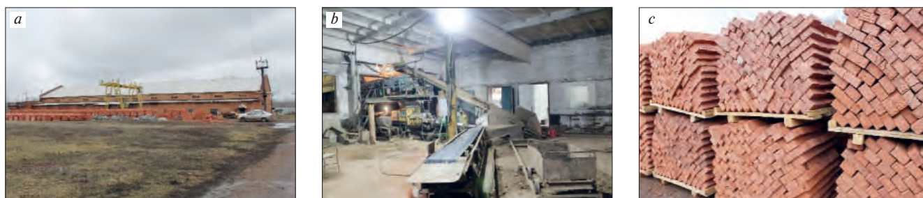
Рис. 5. Бузулукский кирпичный завод: a – производственный корпус завода; b – технологическая линия прессования и резки кирпича; c – готовая продукция Fig. 5. Buzuluk brick factory: a – the production building of the plant; b – the technological line of pressing and cutting bricks; c – finished products
